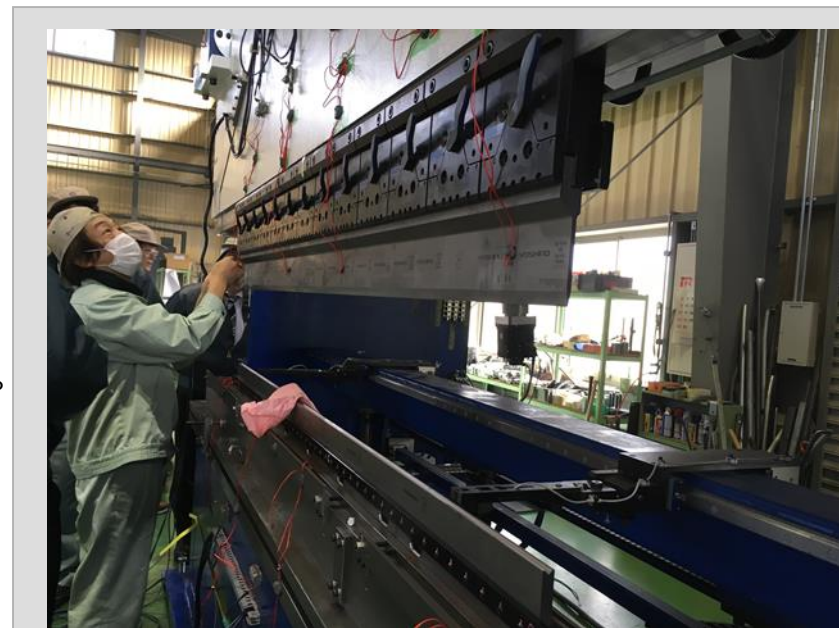
スリット入りラムと特殊キーによるクラウニングゼロ達成試験
