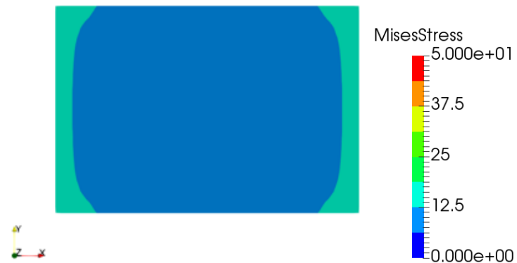
図 2-56 TCT 検証解析 接合層ミーゼス応力コンター図( t=20.130 )
