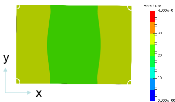
図 2-48 TCT 検証解析 接合層ミーゼス応力コンター図(C 点)
