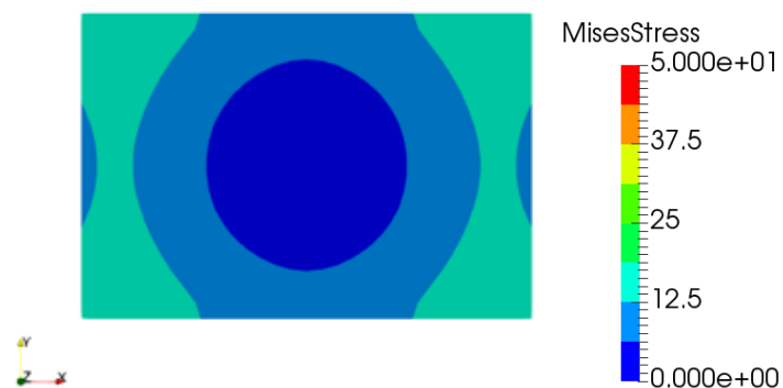
図 2-55 TCT 検証解析 接合層ミーゼス応力コンター図( t=3.960 )
