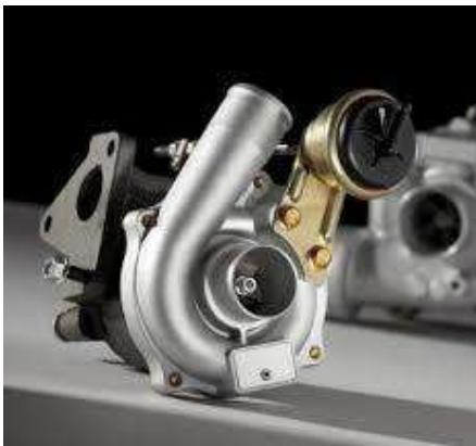
写真1：ターボチャージャー（写真手前部品がアルミ製、奥がステンレス製。）
