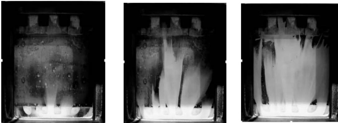
図5 射出速度0.2m/s時の射出状況（左から右に時間経過）
