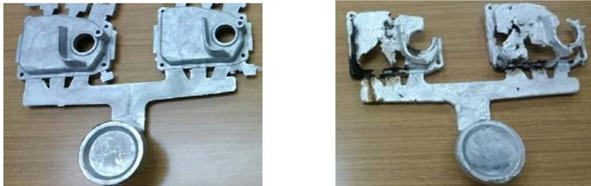
図7 溶湯流動性確認結果（左：ADC12 右：高熱伝導材料）
