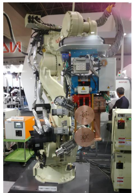
図1. ロボット搭載型アルミ向け シーム溶接機
