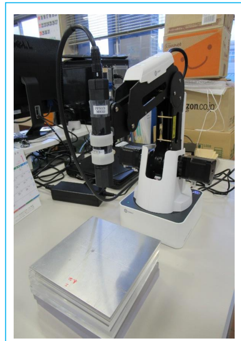
図24. 卓上ロボットを使って 電磁誘導センサーの 検出信号を収集
