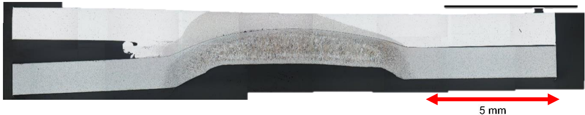
図30. 溶接条件 (No. 5) の金属組織観察
