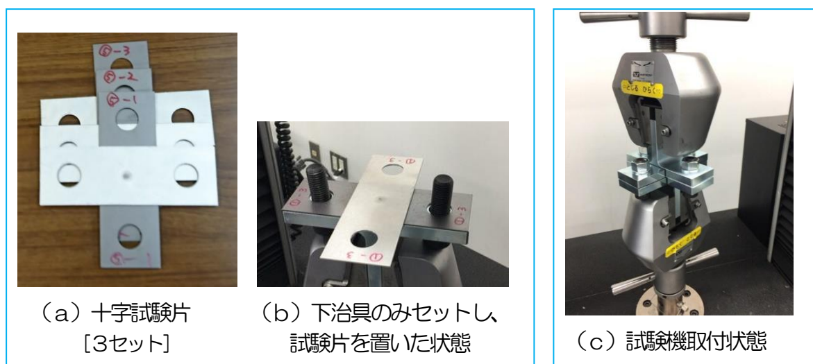
図26. 十字引張試験の様子
