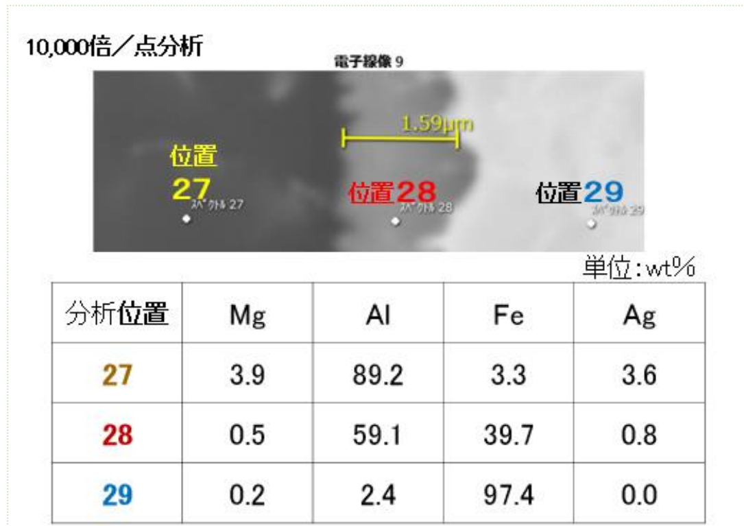
図36. EDSによる鉄／アルミ溶接界面の元素マッピング
