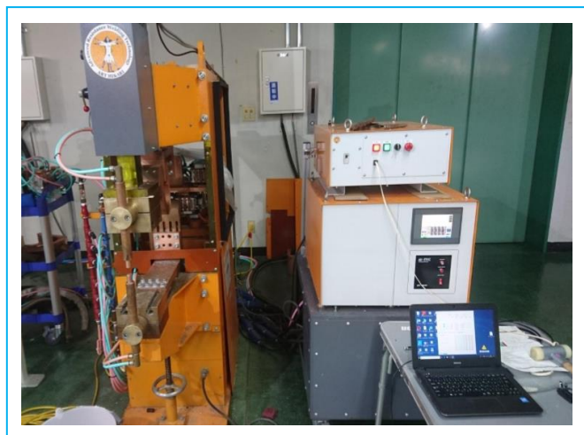
図33. 1年目で使用した定置型スポット溶接機
