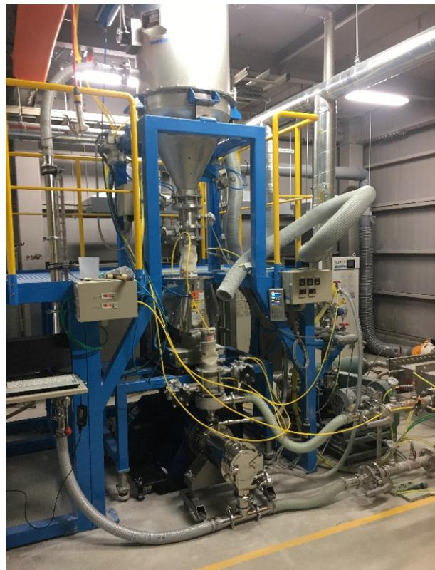
図17 粉体自動移送システムの外観
