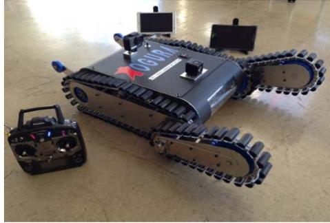
図4 探査型ロボット（2号機）
