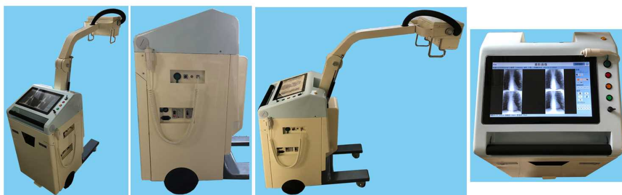
全体 本体側面 全体側面 表示画面 図27 実用化装置（アーム長さ70cm×幅50cm×高さ80cm以内、筐体重量約95kg）
