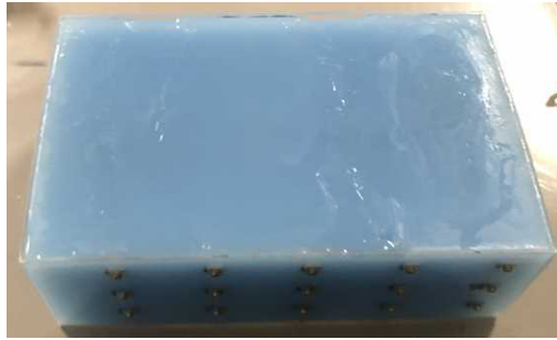
図15 実際に製作したコッククロフトモールド (W29cm×D18cm×H9cm 6.1kg)
