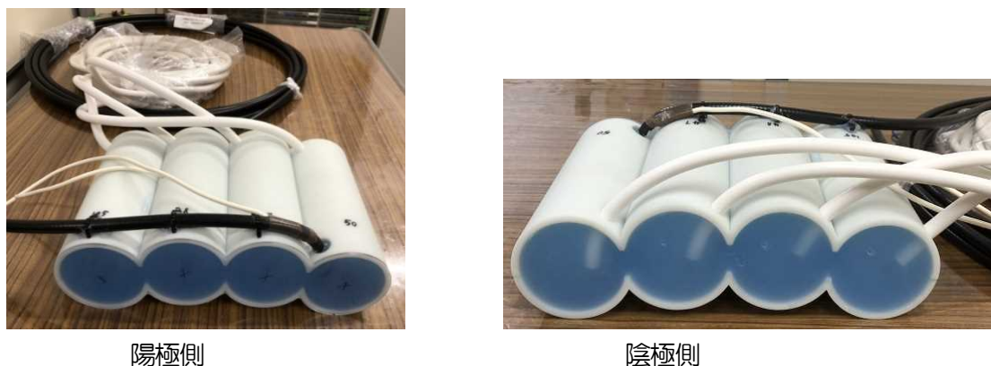
図14 実際に製作した4管モールド (W29cm×D19cm×H9cm 重さ6.9kg)
