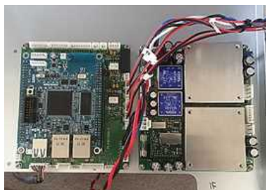
図23 X線パルス同期回路、パルス幅可変回路
