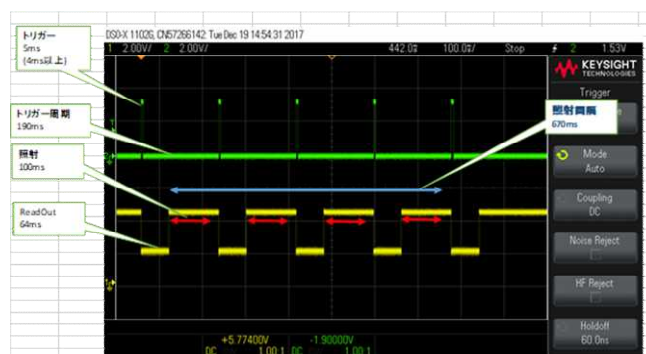
図25 パルス幅可変およびX線パルス同期回路試験（オシロスコープ画面）
