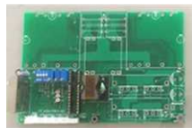
図18 高電圧発生回路（左：陽極用、右：陰極用） 図19 電源回路（ACバ ッテリ-両用、陽極2、陰極1）
