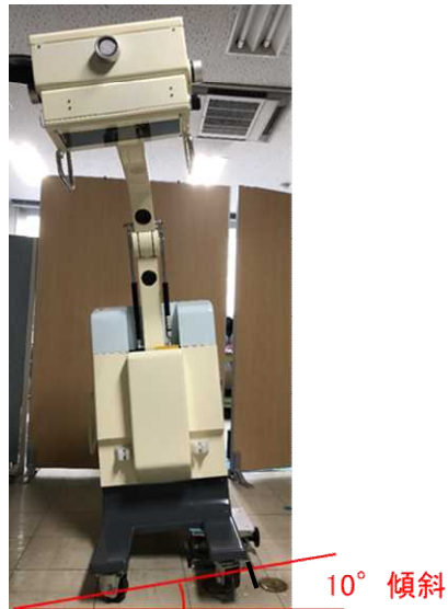
図 45 筐体 10° 傾斜時、転倒測定
