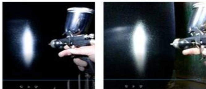
図 2-1-7 従来品と造形品のスプレー実験比較
