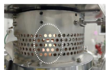
Cl 2 プラズマ放電状態
