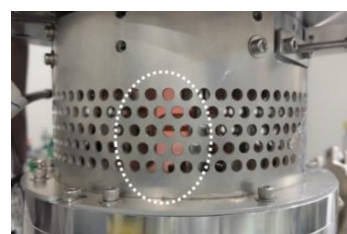
SF 6 プラズマ放電状態
