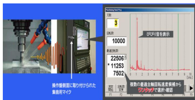
図 2-3 振動抑制機能付き工作機械の構想
