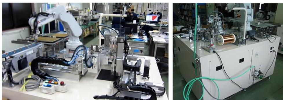
図8 高速・高密度巻線システム
