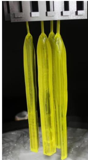
図 18 5本20x20mm角柱状マルチFEG法作製YAG結晶
