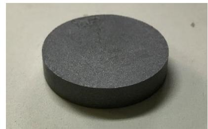
図10 φ30mm一軸加圧成形体
