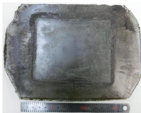
図 20 A5 サイズの熱間成形加工材の外観写真
