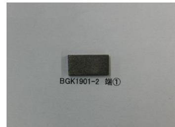
図 21 電気抵抗測定用試験片
