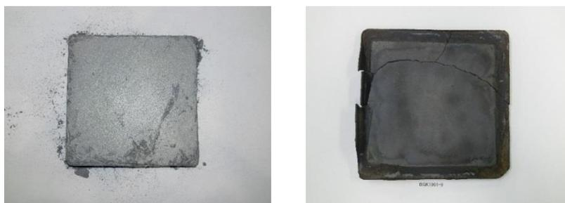
図 12 無加圧焼結前の一軸加圧成形体とその熱間成形加工材
