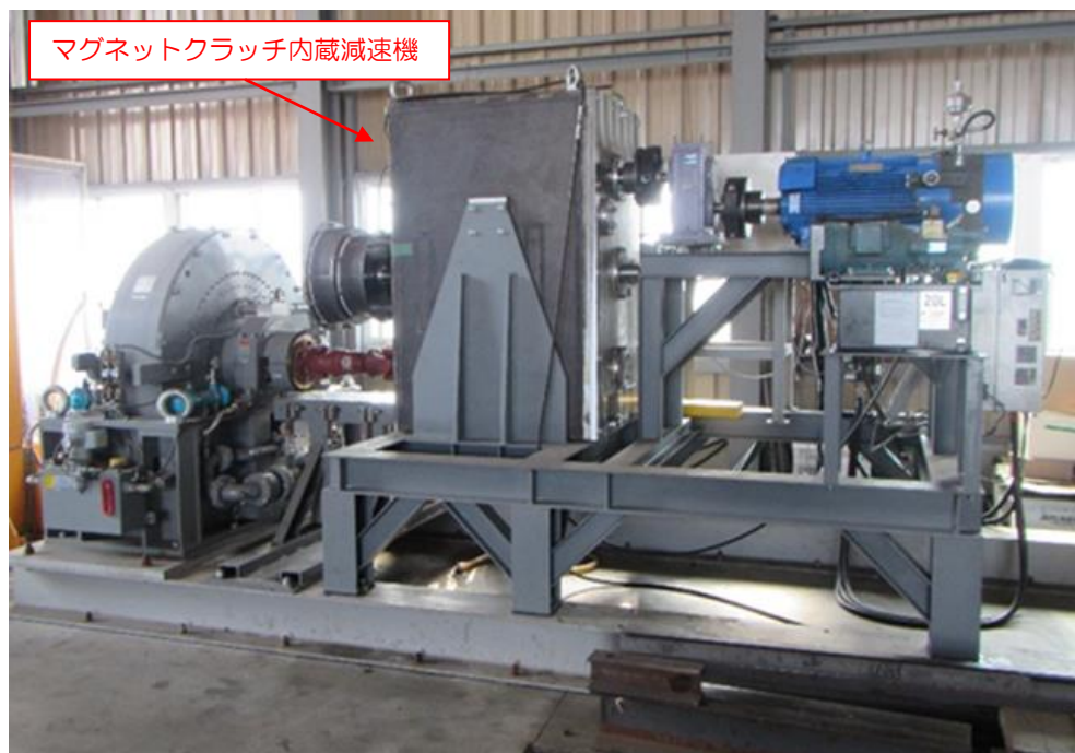
図 2-3-1. マグネットクラッチ耐久試験（東洋機械(株)名取工場内 試作評価ベンチ）
