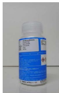
燃料電池用カソード電極触媒 (Pt/C)
