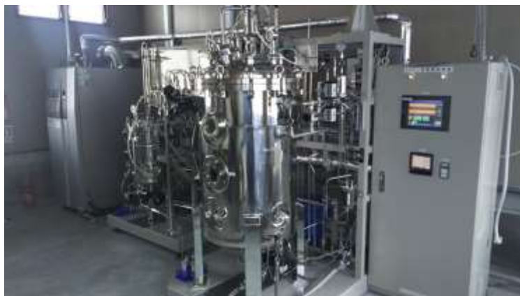
左：30Lファーマンター、右：300Lファーマンターと制御板
