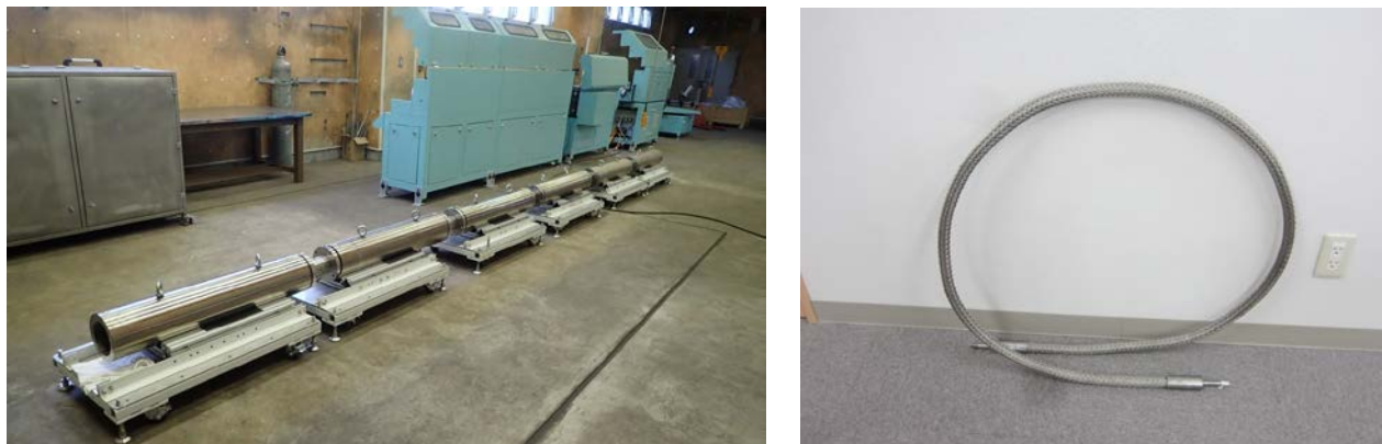
図15 増設した水圧式チューブ圧密装置(左)と3mのチューブ(右)
