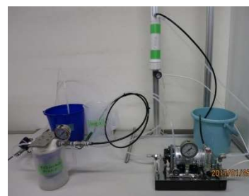
図 48. 卓上型ファウリング試験装置 (スパイラル膜モジュールタイプ)
