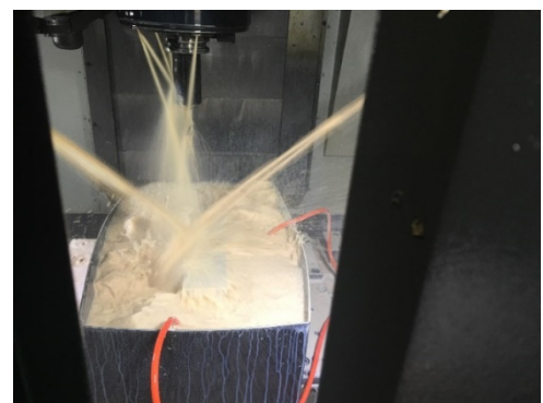
クーラント液中の切削加工
