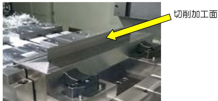
図 1 8 R 刃エンドミル切削工具による切削加工実験の加工面の写真
