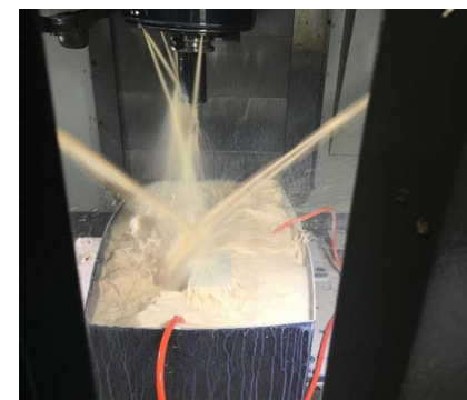
クーラント液中の切削加工
