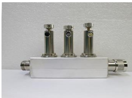
図 1 9 付加したマイクロ波用小型スリースタブチューナーの写真。
