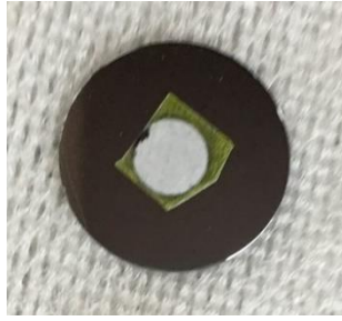
図 1 7 70Wのマイクロ波を投入し、1分間プラズマ処理した後の80℃のサーモラベルの写真。
