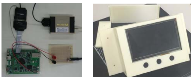
図 30 平成 27 年度試作品ホームサーバー(右：3D プリンタで作成した筐体)
