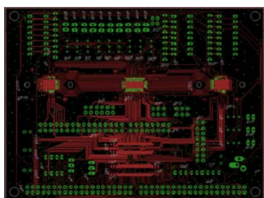
図7 PCB基板インタポーザ基板(親基板)
