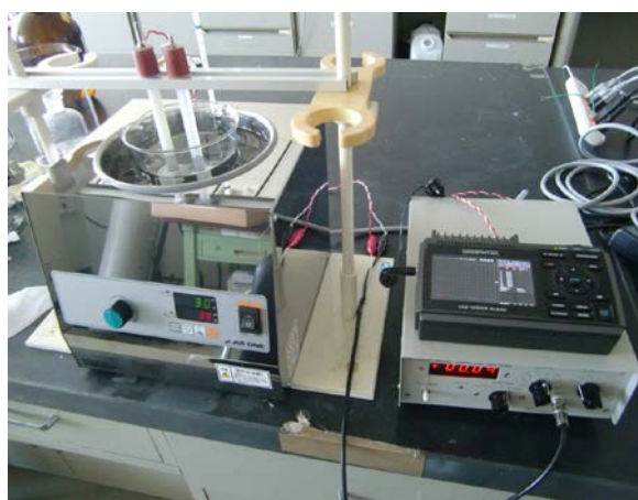
図 11 電食評価装置の概要
