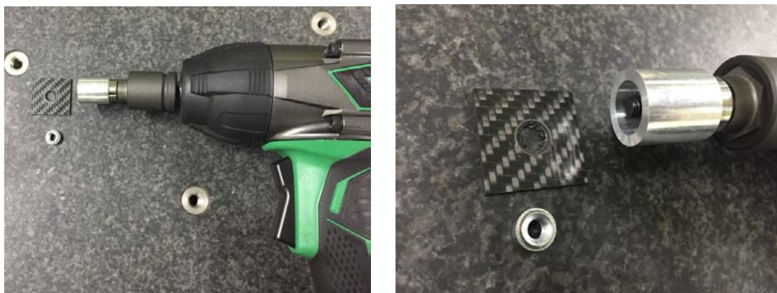
図 13 ファスナー取外し装置の概要
