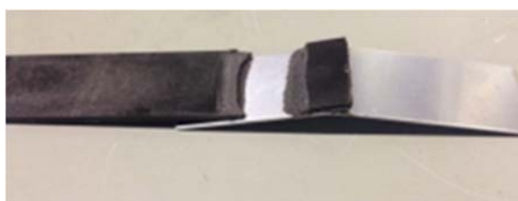
図 14：最高強度品の強制破壊状態
