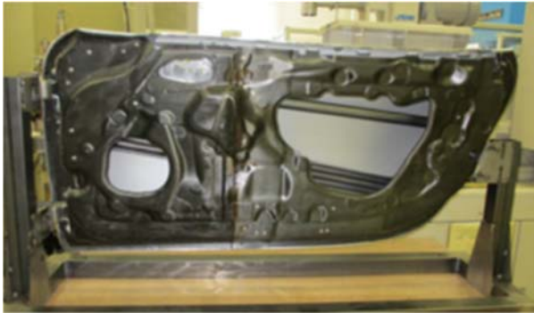
図27:自社製作した樹脂と金属の複合素材ドア
