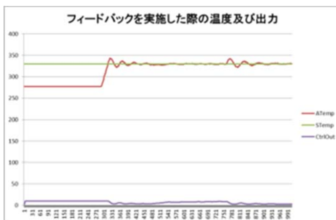
図 15：フィードバックによる照射表面温度
