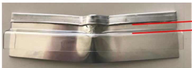
図 23：接合品による潰し実験試料
