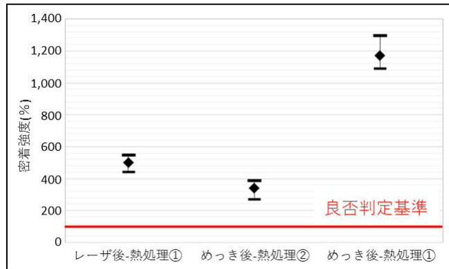
図 26 密着強度の測定結果
