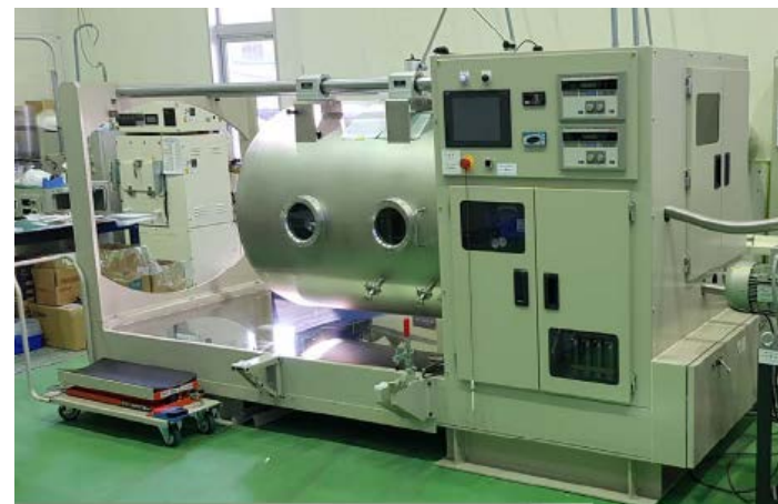
型式:真空チャンバー式 処理能力:両面一括処理 処理速度:0.5~18m/min 有効処理幅:500mm 処理幅1000mmの電極を開発
