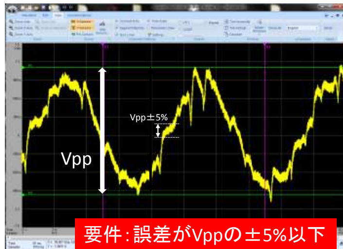
図 1 2 アーク放電ノイズの誤差の考え方
