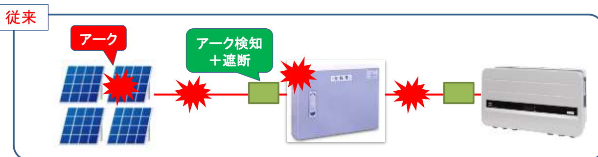
(a) 従来の電路遮断の手法
