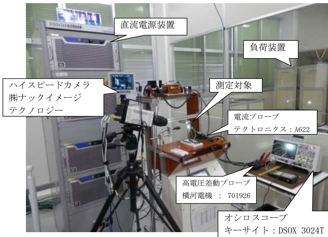
写真 8 アーク放電を観測する実験装置
