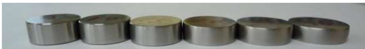
図 2-1-1-2 冷間鍛造サンプル (圧下率は左から 5、10、15、20、25、30%)
