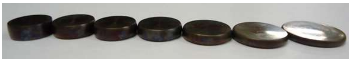
図 2-1-1-3 温間鍛造サンプル (圧下率は左から 15、20、25、30、40、50、60%)
