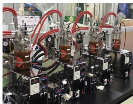
図3 試験に用いた微生物培養槽
