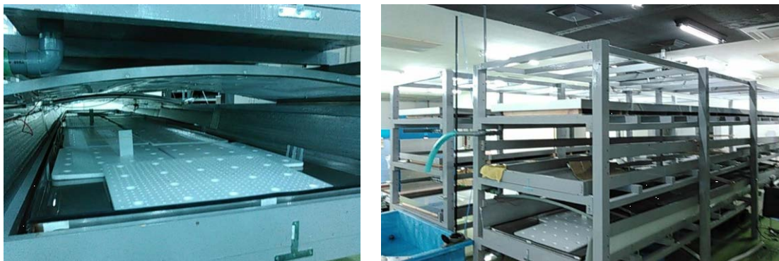
図9 セル内部の栽培トレイ（左）と間伐材を用いた手動型ユニットの骨格部分（右）
