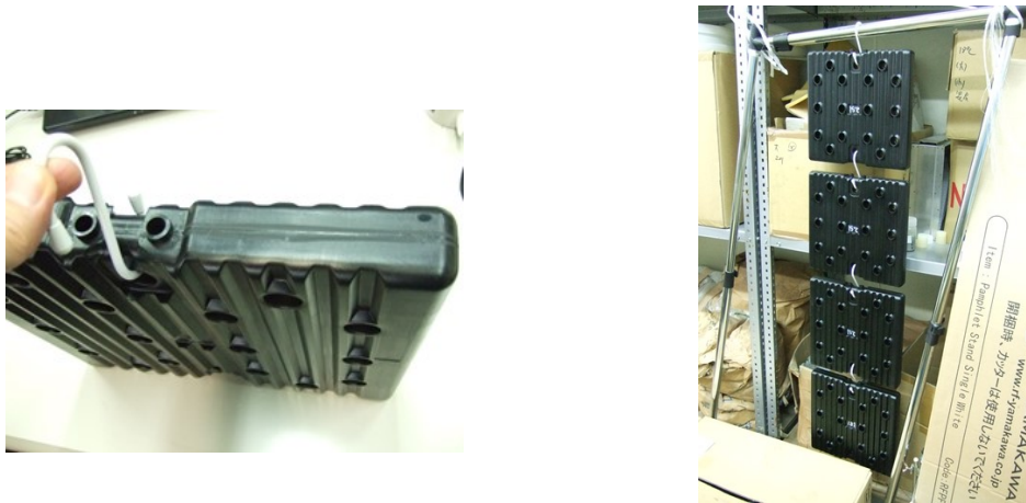
写真 11 大容量蓄熱資材の中央部分と S 字フックを用いた設置状況
