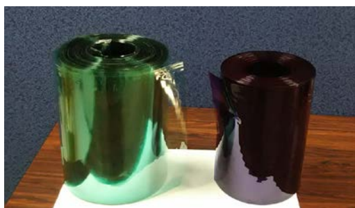
写真 4 作製した遠赤外・近赤外蛍光色素を含む波長変換フィルム 図 2 ホウ素錯体系色素の吸収・蛍光スペクトル (クロロホルム中)
