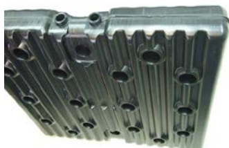
写真 3 改良された大容量カプセル (B2b 型) 図 1 純水と水道水による蓄熱資材 (B2b 型) の温度サイクル試験
