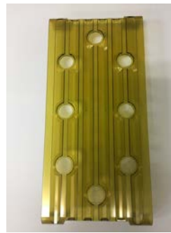
写真7 集熱カプセルジャケットの成形品 (左側：成形品、右側：蓄熱資材に装着した状態)
