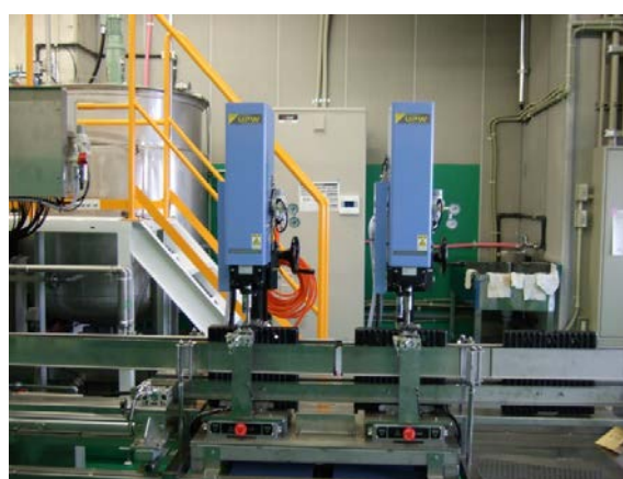
写真10 自動封止装置部分
