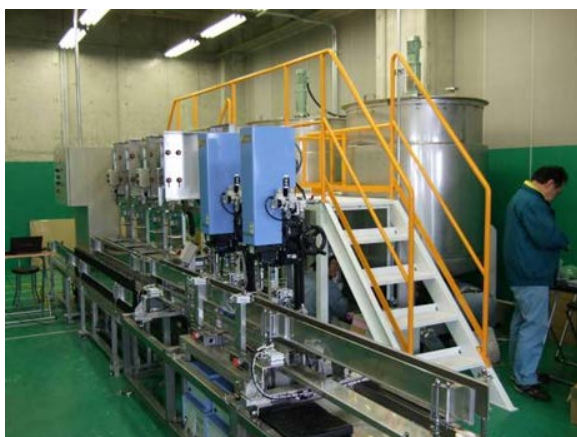
写真9 蓄熱材封入を含む蓄熱資材の自動製造装置
