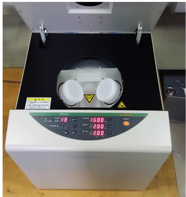
図 44 自転・公転ミキサーの内部構造
