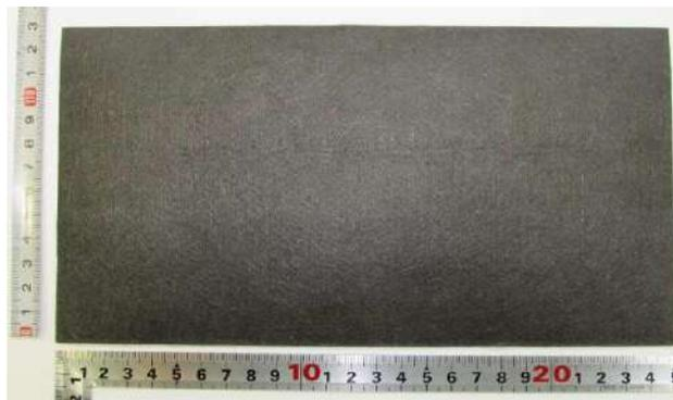
図 2-2-16 中型機処理用炭素繊維クロス 230×130 mmの外観写真
