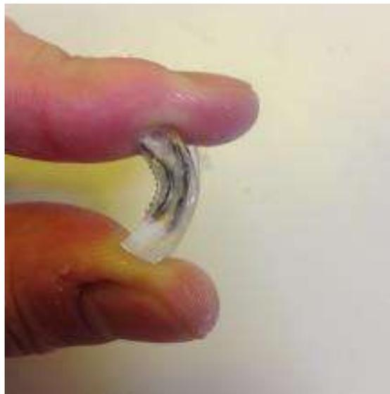
図 2-7-2 作成した燃料電池の電極部の写真
