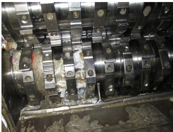
図 18 二軸剪断式破砕機内部
