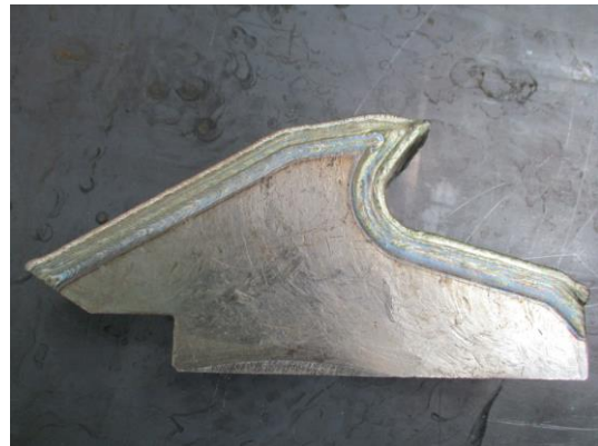
図 26 肉盛溶接後の刃物 2
