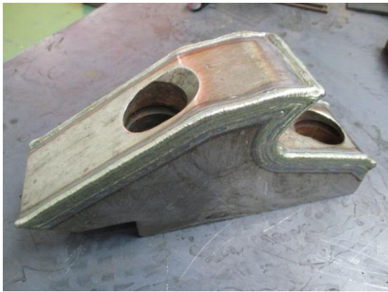
図 25 肉盛溶接後の刃物 1
