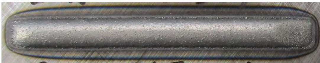
図 21 ビードオンプレート試験外観
