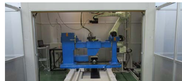
レーザー粉体肉盛溶接 研究装置
