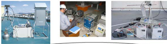
測定対象物質により捕集法が異なるので、機材が多く煩雑。経済的な負担も、.....
