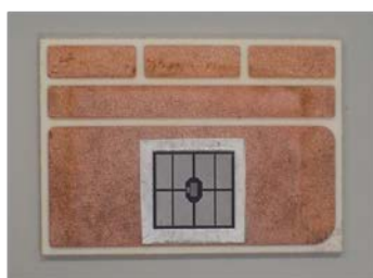
DBC基板にIGBT接合した試料
