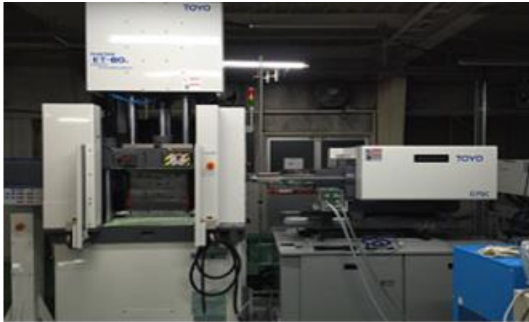
図 25. 実験用トランスファ成形機と射出サブユニットの設置状態
