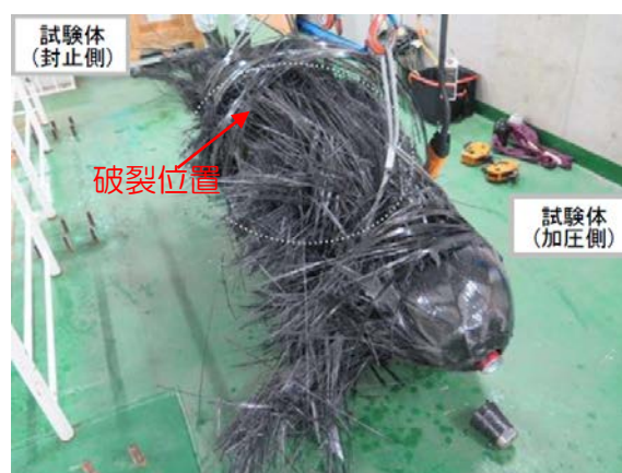
図10. 破裂試験後の容器
