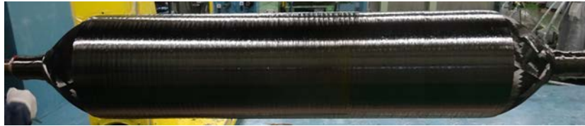
図9. 製作した開発A材を用いた TYPE3 複合蓄圧器
