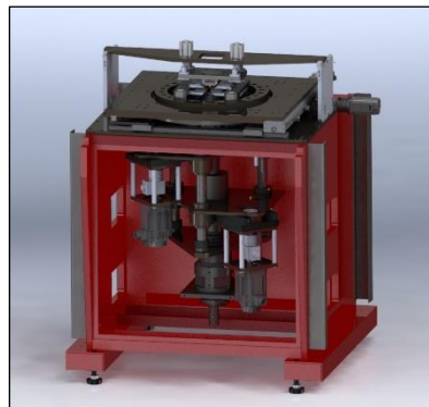
予熱機構を有する同軸 スピンドル式小型F S W装置
