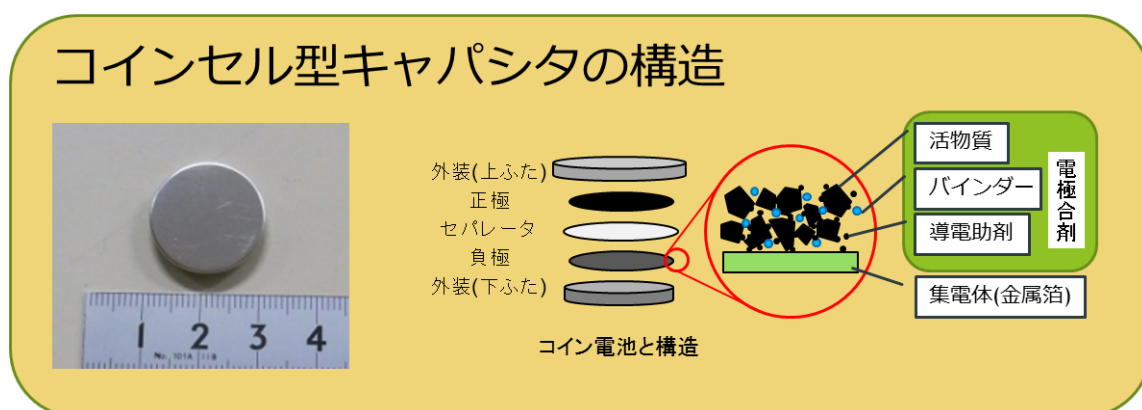
図 2.3.19：コインセル型キャパシタの構造
