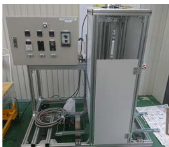
図 2.1.9 ナノファイバー用押出装置
