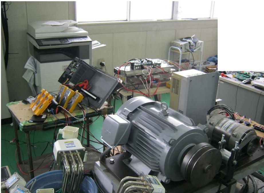
図 11. 発電機の一定電圧、巻線切替の試験状況
