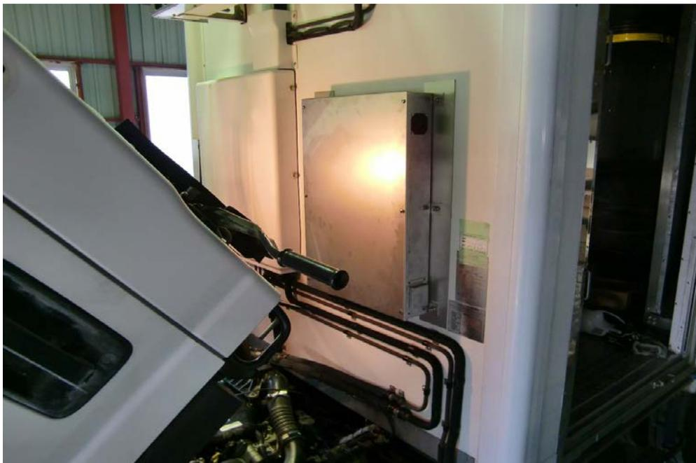
図10.上田事業所冷凍車の制御装置取付状態
