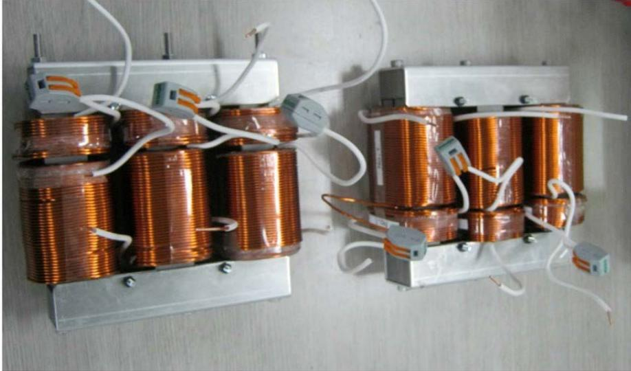
図7.4.5kW発電機用チョークコイル
