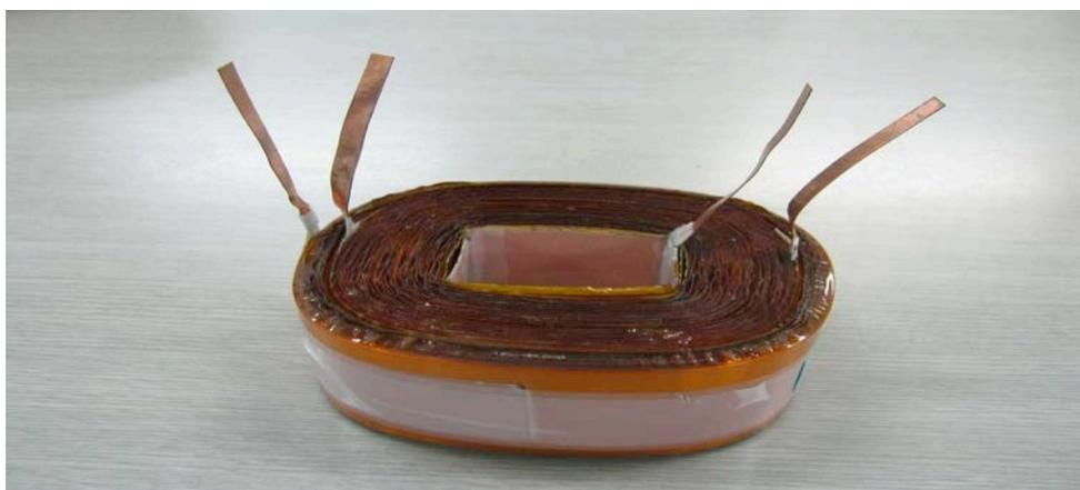
図-2: 薄板銅板による超小型チョークコイル
