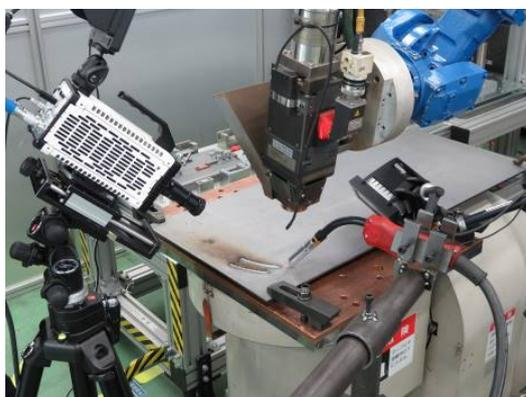
図 16 レーザ・アークハイブリッド溶接実験の状況
