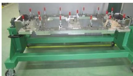
図35 フランジ溶接治具
