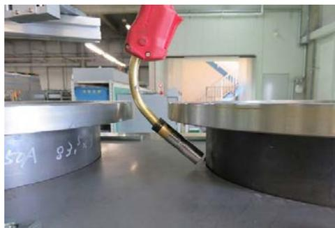
図34 先端を曲げた専用トーチ
