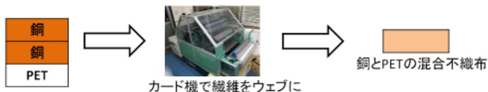
図24 ウェブ作製のイメージ図
