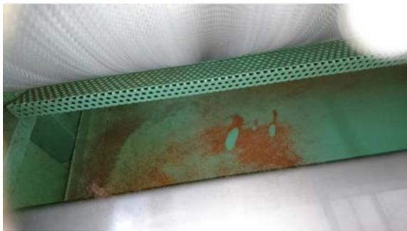
図10 原綿にメッキをし、カード機に3回通した後のカード機の受け皿の様子
