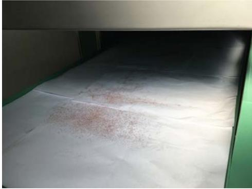
図1 2 ウェブにメッキをし、カード機に1回通した後のカード機の受け皿の様子
