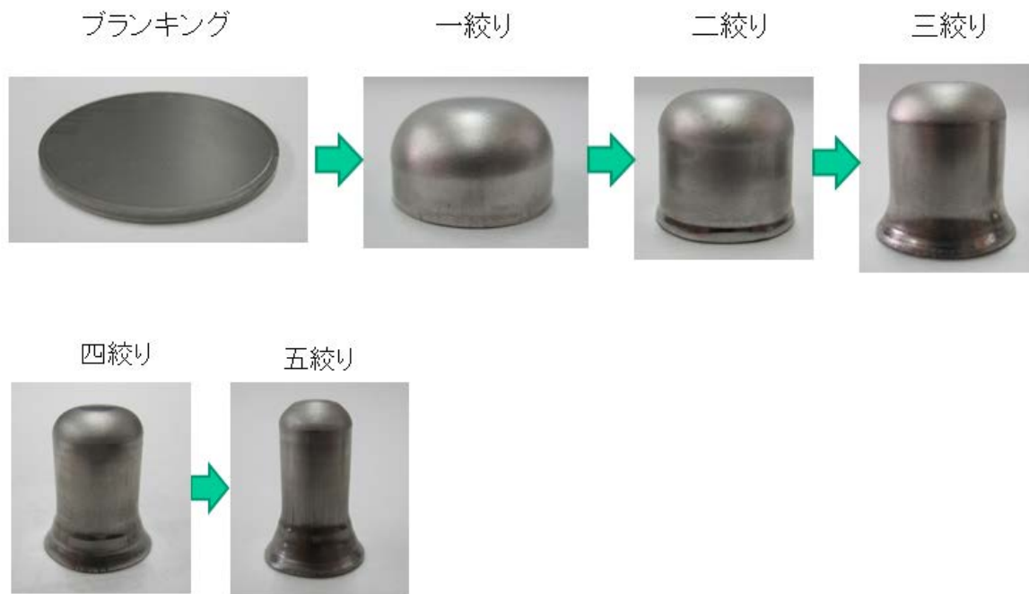
写真 2.7 接触角度 26 度のダイによる加工結果
