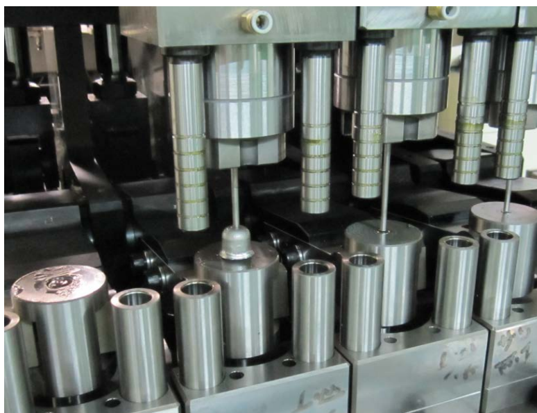
写真 2.3 テスト金型によるトライ
