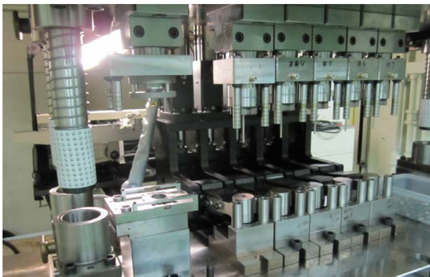
写真 2.2 テスト金型及びサーボ複動機構取付状態
