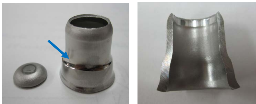
写真 2.6 3 絞り工程加工結果（下死点）
