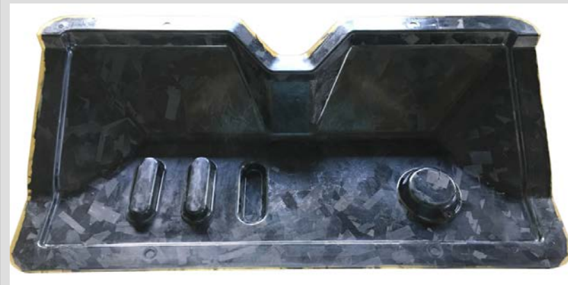
HP-RTMによる実形状成形品
