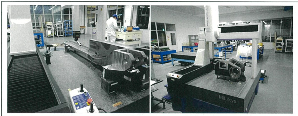
図 24.三次元測定器による主要部品測定
