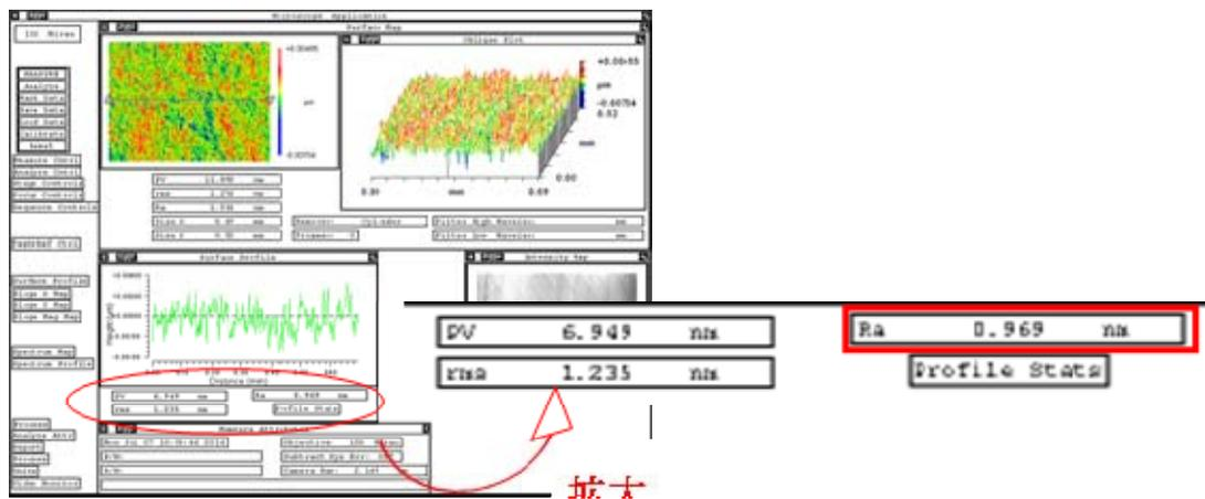
その測定器の測定エリアは  $0.7 \times 0.6\text{mm}$  なのでウエハ全体を評価することが出来ない。
