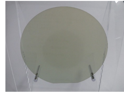
加工したSiC基板
